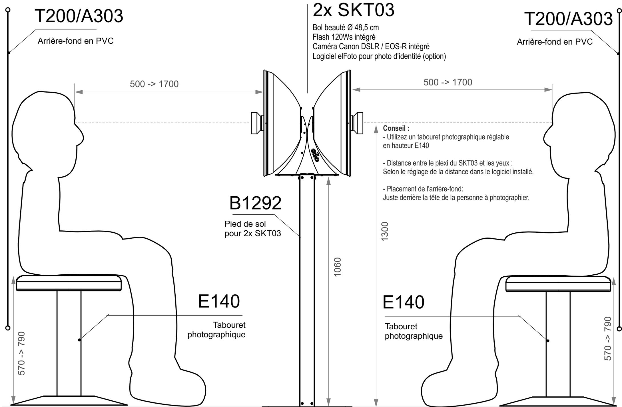
Exemple de disposition : 2x SKT03 Système Photo d'identité avec statif robuste sur plateau de sol
